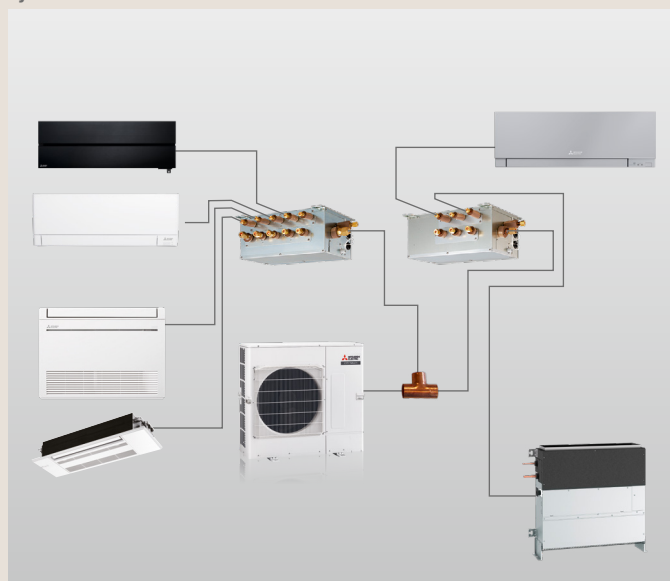
Systeemvoorbeeld met maximaal acht binnenunits
