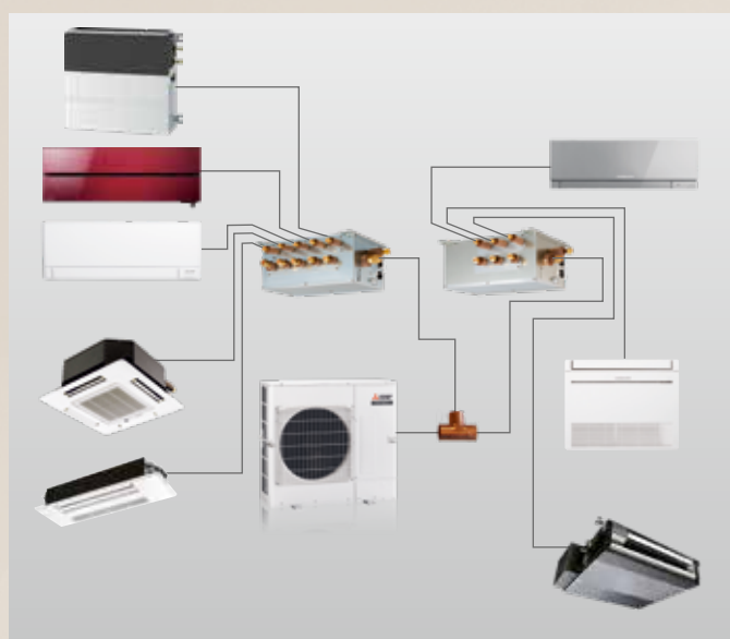
Exemple de système avec huit modèles d'unités intérieures
