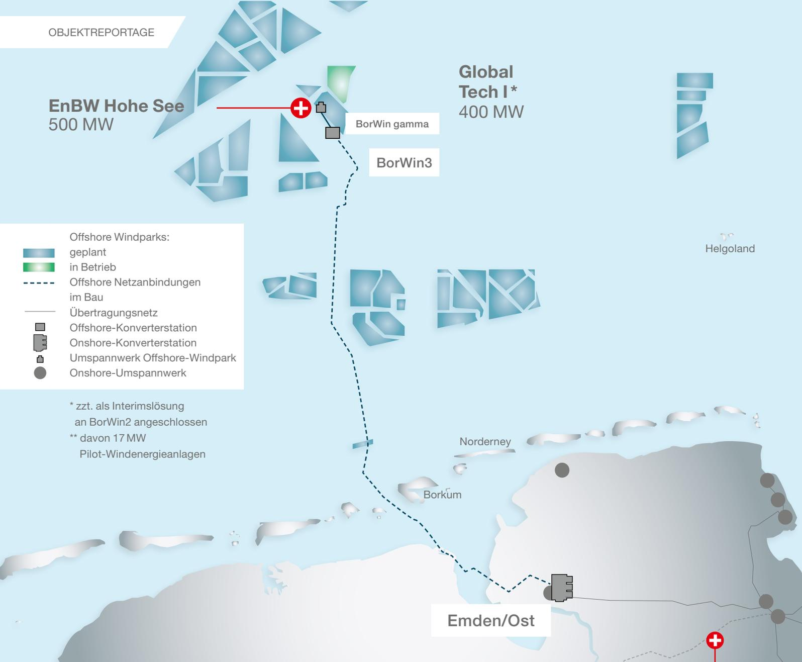
Der auf See erzeugte Drehstrom wird in Gleichstrom umgewandelt und mit einem Seekabel sowie einem Erdkabel zur Konverterstation nach Emden/Ost übertragen.
