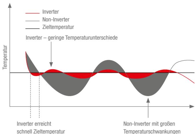
Inverter-Technologie sorgt für schnelles und zielgenaues Erreichen der gewünschten Temperatur. So werden aufwändiges Nachregeln, große Temperaturschwankungen und der damit verbundene Effizienzverlust zuverlässig minimiert.
