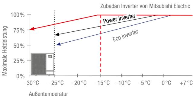
Mit zuverlässigem Wärmepumpenbetrieb selbst bei  $-30^{\circ}\text{C}$  und voller Heizleistung bis  $-15^{\circ}\text{C}$  verfügt die patentierte Zubadan Inverter-Technologie über ein deutlich größeres Leistungspotenzial als herkömmliche Systeme.
