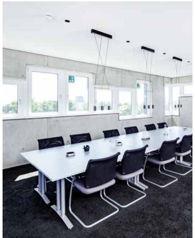
Die erforderliche Helligkeit in den verschiedenen Räumen des Bürogebäudes (Büros und Besprechungszimmer) wird durch bewegungsgesteuerte Flächen-LED-Strahler erreicht.
