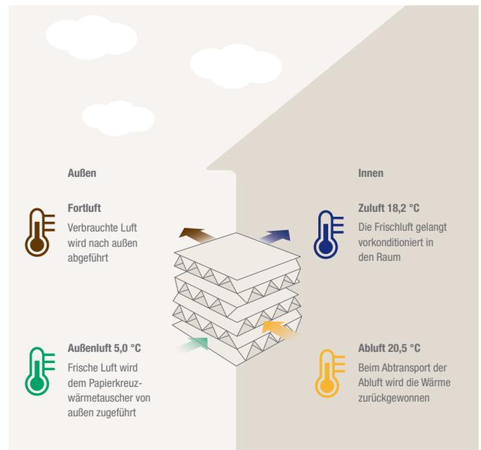
Die Struktur des Lossnay Papierkreuzwärmetauschers
