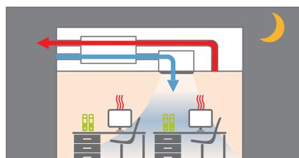
Sobald die Außentemperatur niedriger als die Raumtemperatur ist, startet die Belüftung automatisch.
