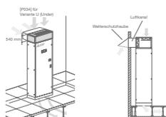
**Luftansaug-Plenum mit Free-Cooling Jalousieklappen**
