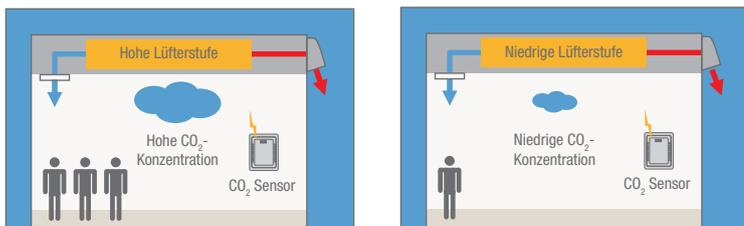
Die Lossnay-Geräte der Serien LGH-RVX(T)3 verfügen standardmäßig über einen Anschluss für einen bauseitigen CO<sub>2</sub>-Sensor.
