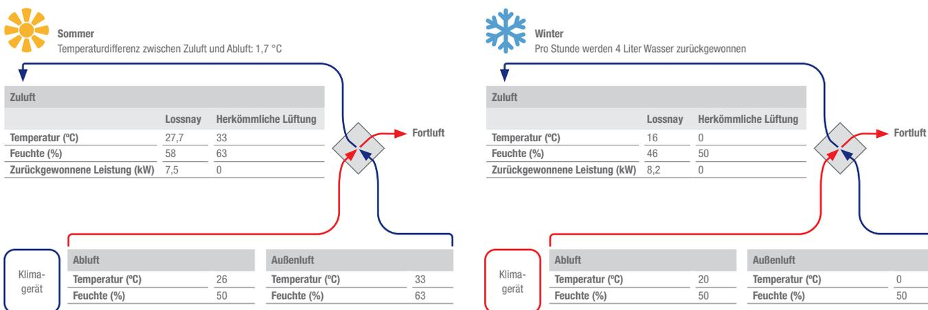
Im Gegensatz zu einer herkömmlichen Lüftung ist mit einer Lossnay-Lüftung im Sommer nicht nur die Frischluftzufuhr gewährleistet, sondern auch eine Temperatur- und Feuchteregulierung, die einer Einsparung von 7,5 kW entspricht.
