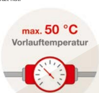
Grundsätzlich gilt: Je niedriger die Vorlauftemperatur, desto effizienter arbeitet eine Wärmepumpe. Gleichzeitig muss die Heizkörperleistung bei dieser Temperatur die Heizlast des Raumes decken. Zwar sind bei heutigen Wärmepumpen Vorlauftemperaturen bis über 70 °C möglich, ein Dauerbetrieb ist jedoch nicht empfehlenswert. Ziel sollte eine Reduktion auf maximal 50–55 °C oder weniger sein.
